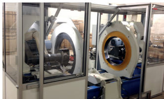
Machine réalisée sur-mesure pour l'usinage automatique de tonneaux.
